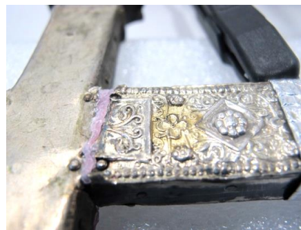
Fig. 72 : Définition des paramètres de traitement avec le pinceau électrolytique sur la plaque 5 de la croix reliquaire de la Vraie croix. Tracé de voltammétrie linéaire anodique porté à 1000mV/C. vitreux et zone nettoyée (à droite ci-dessus).
