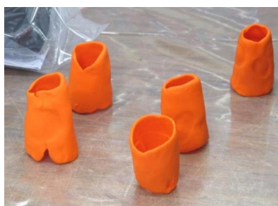
Fig. 134 : Empreintes de préhension du prototype du pinceau en pâte FIMO®, © Crédit EDANA.
