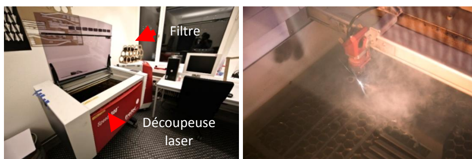
Fig. 126 : Vue de la découpeuse laser Trotec Speedy 300 et découpe en cours sur une plaque en polyéthylène (PE), © Crédit FabLab.
