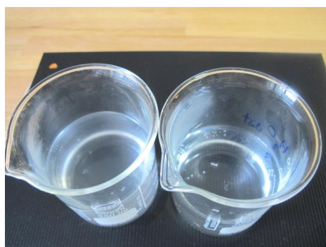
Fig. 83 : Eau de rinçage du tampon PVA ADW® (à gauche, rinçage à froid ; à droite : blanc (eau déionisée)).
