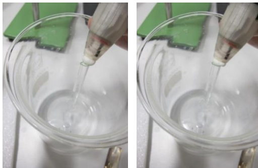
Fig. 182 : Rinçage du tampon par pression contre le tube d'un entonnoir en verre renversé et placé dans un bécher.
