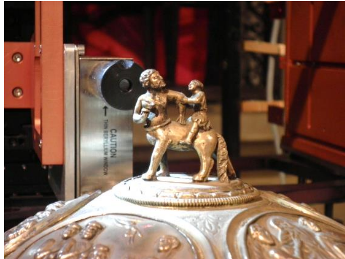
Fig. 9 : Analyse d'un élément de la coupe dite de Charlemagne (XIII e siècle) avec la fluorescence X portable du Centre de Recherche et de Restauration des Musées de France. Le détecteur est visible à l'arrière du centaure. Projet mené avec le soutien financier du projet CHARISMA.
