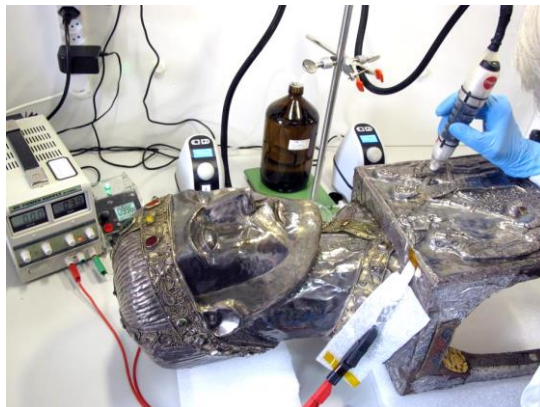
Fig. 173 : Traitement en mode chrono-ampérométrique du chef reliquaire de saint Cyprien à l'aide du Pleco. A gauche le générateur de tension/courant et le système de contrôle du potentiel. A droite le Pleco et à l'arrière-plan le système des pompes et le réservoir de solution.
