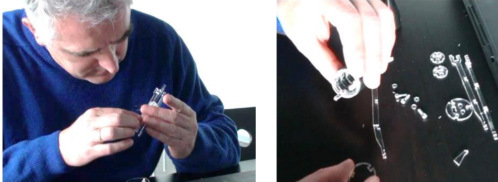
Fig. 144 : Tentative de montage du piston et casse d'un des montants en PMMA.
