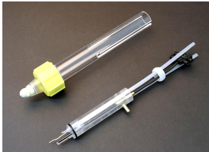
Fig. 48 : Les composants principaux du 2 ème prototype du pinceau électrolytique. En haut à gauche l'enveloppe extérieure munie de fentes de part et d'autre de son diamètre à laquelle est fixée l'embout par la bague fileté, en bas à droite le piston intérieur muni des électrodes et des tuyaux d'amenée et d'extraction des solutions.
