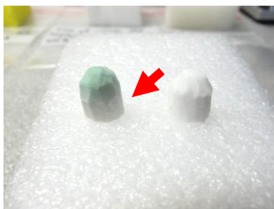
Fig. 107 : Aspect de surface d'un tampon PVMF AION® usagé lors de la 1 ère polarisation cathodique (voltammétrie suivie de chrono-ampérométries) menée sur un des éléments de la manche du bras reliquaire de saint Bernard, en comparaison de l'aspect d'un tampon simplement rincé (a) et spectres de fluorescence X du tampon rincé et du tampon PVMF AION® après polarisation (b).
