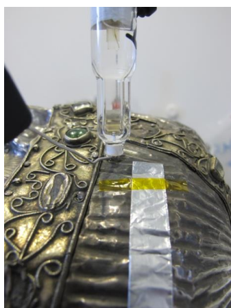
Fig. 154 : Conditions de l'étude électrochimique et électrolytique sur le chef reliquaire, mode à la goutte.
