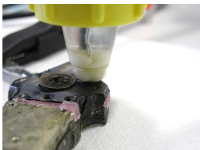
Fig. 67 : Définition des paramètres de traitement avec le pinceau électrolytique sur la plaque 6 de la croix reliquaire de la Vraie croix.
