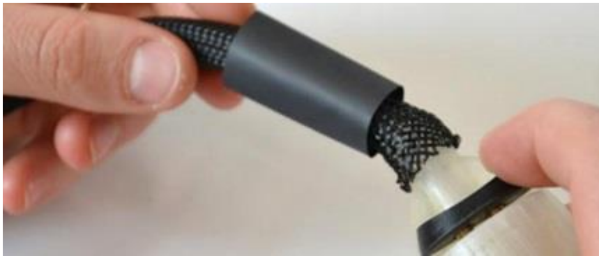
Fig. 151 : Vue de la gaine en tissu tressé et de la gaine thermo-rétractable avant chauffage.
