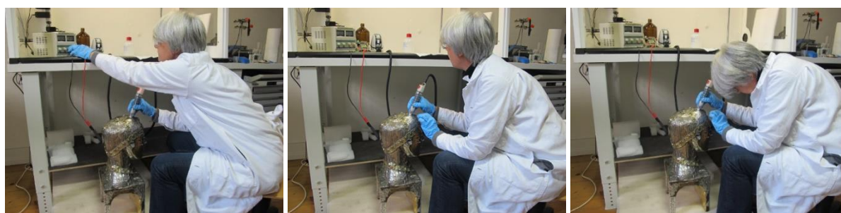
Fig. 186 : Application des paramètres de traitement pour le nettoyage des cheveux du chef reliquaire (a), contrôle visuel du potentiel appliqué (b) et déplacement du pinceau sans contrôle visuel du potentiel appliqué (c).
