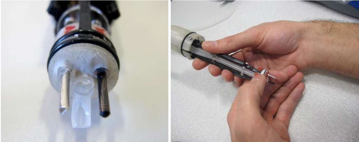
Fig. 187 : Application de plastiline au niveau de la tête du piston pour renforcer l'étanchéité du pinceau.
