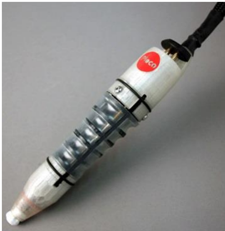
Fig. 152 : Vue du Pleco finalisé, entièrement monté et muni d'un tampon en PVFM AION®.
