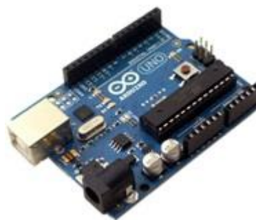
Fig. 123 : Vue de la carte imprimée et du microcontrôleur Arduino, © Crédit Arduino Software.
